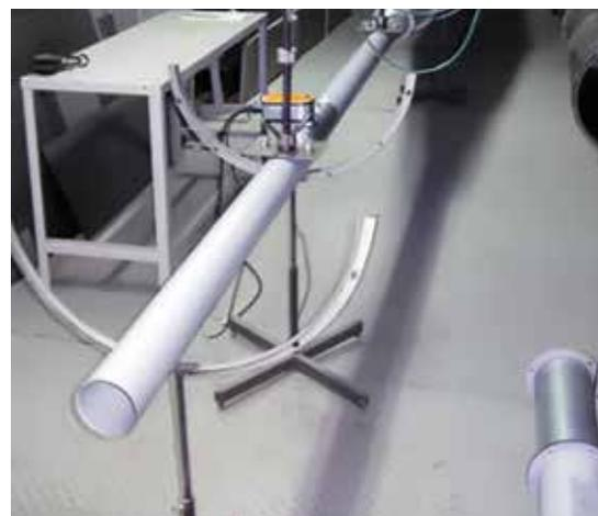
Стенд для проведения аэродинамических испытаний
